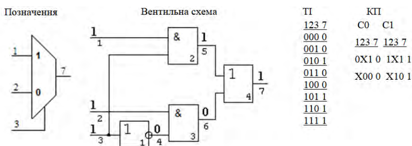
Рис. 5. Структурно-функціональна модель мультиплексора MUX 2-в-1
