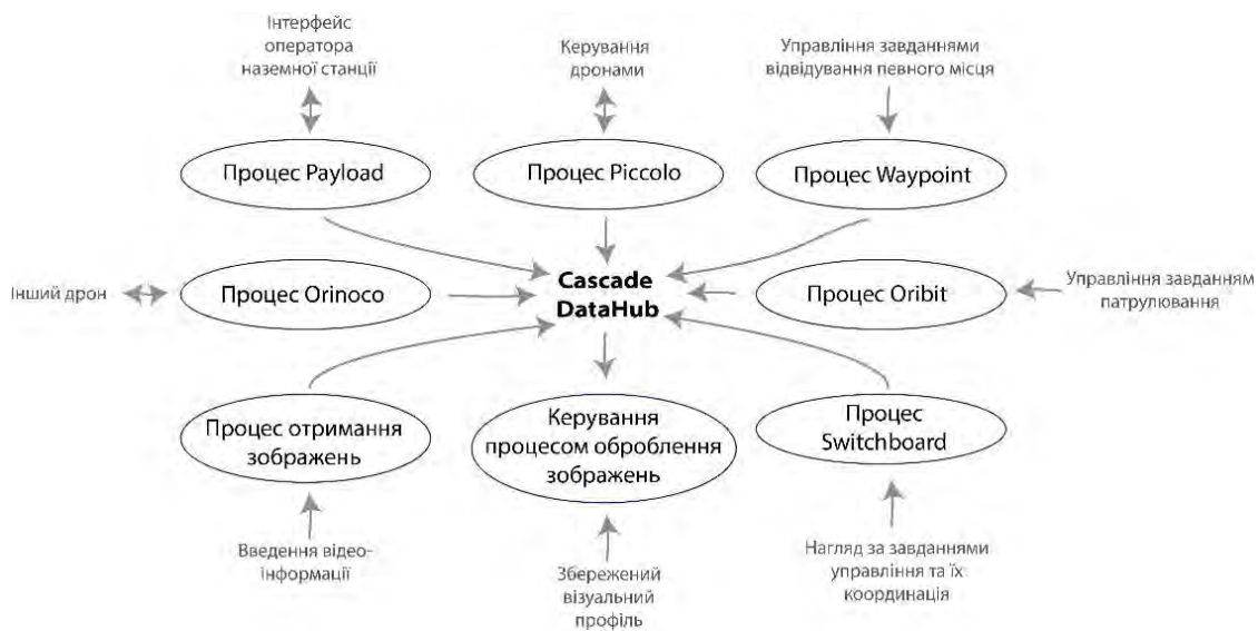
Рис. 5. Схема взаємодії процесів за допомогою Cascade DataHub у системі розподіленого управління дронами
