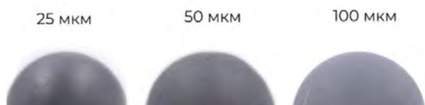
Рис. 5. Моделі із шарами 25 мкм, 50 мкм та 100 мкм
